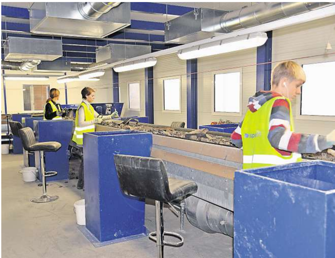
In der Handlesestation entfernen Mitarbeiter Eisen-Kupfer-Teile, Meatballs genannt, von gewöhnlichem Eisenschrott. Bild: pd
